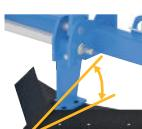
Регулируемый рабочий орган. Изменение угла вхождения (атаки) при работе на твердых почвах;
